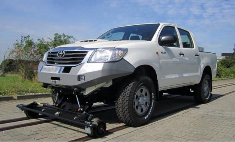
*Pick-up mit Schienenführung
