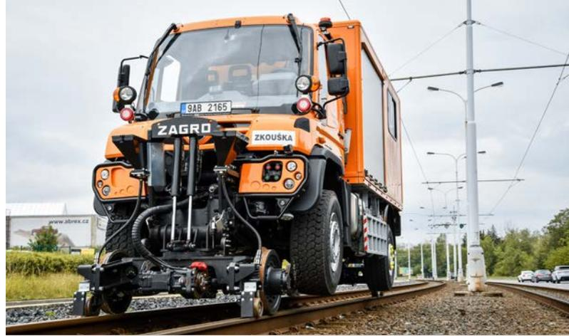
*Unimog U 527 mit hydrostatischer Schienenfahreinrichtung
