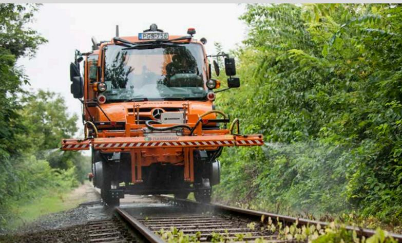
*Unimog U 423 mit Spritzeinrichtung zur Vegetationskontrolle
