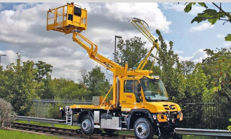
*Unimog U 423 Oberleitungsmontagefahrzeug unabgestützt verfahrbar
