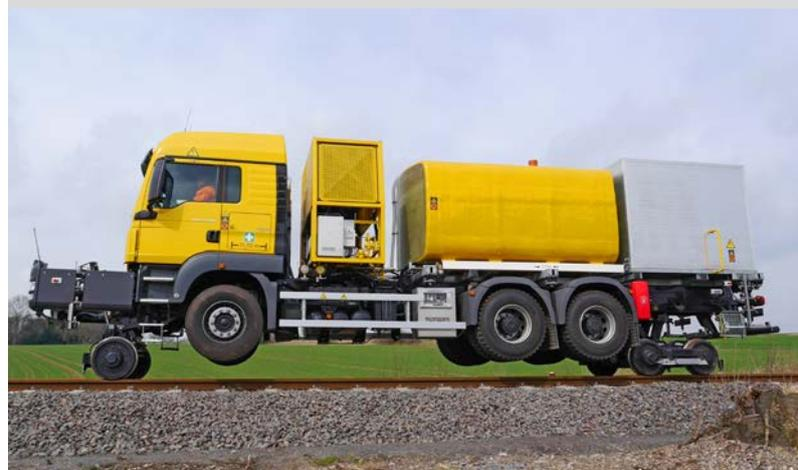
*Gleispflegefahrzeug mit Tanks
