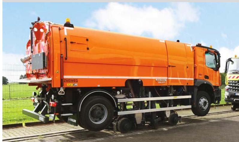
*Rillenreinigungsfahrzeug mit Lore-Schienenführung
