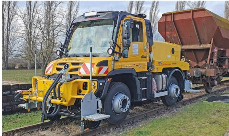
Unimog U 423 Rangierfahrzeug, Laufräder Ø 400 mm
